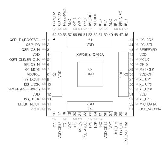
Fig. 4.1: XVF3615-QF60A pin configuration
